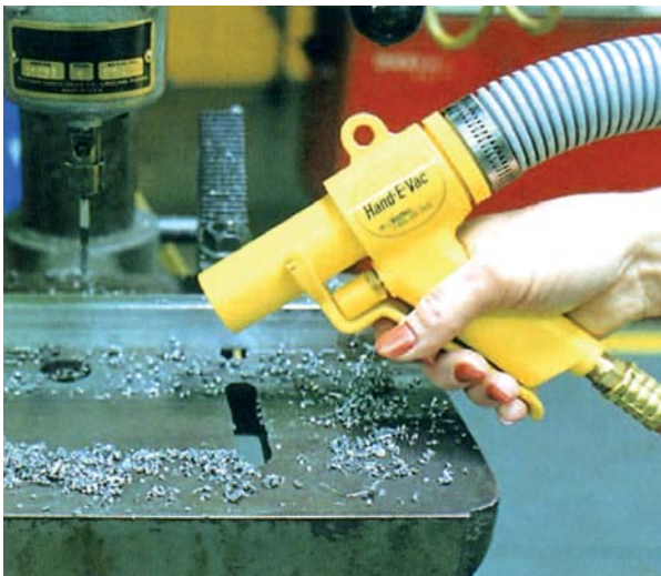
Aspiration de copeaux avec pistolet 2002.
