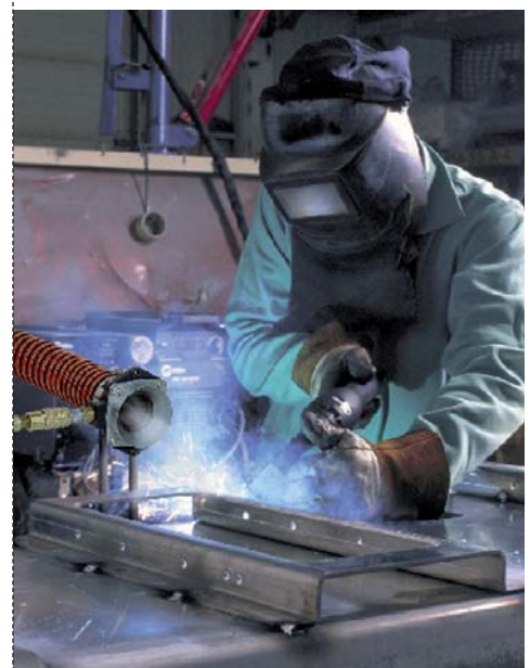
Évacuation de fumée de soudage par Transvector.
