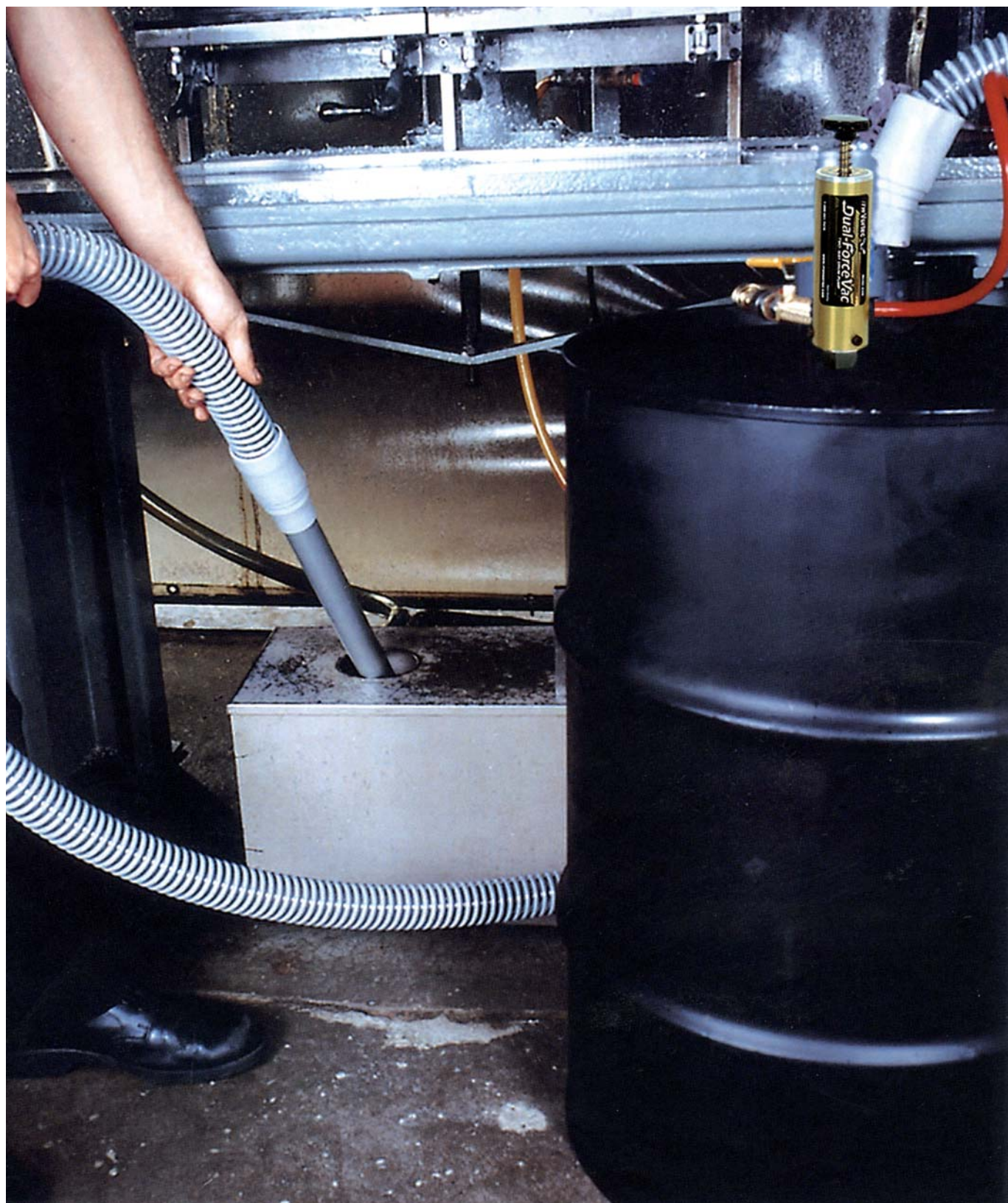
La pompe de fûts 2109 permet de capter les liquides avec un débit de 170 l/min.
