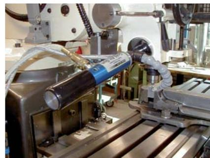
Le pistolet d'air glacé 606 ML refroidit pendant la micro-lubrification.
