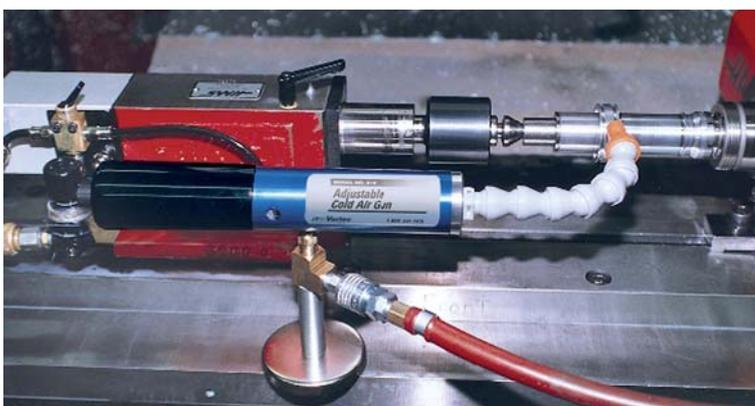
Pistolet d'air glacé 610 : application de refroidissement localisé.
