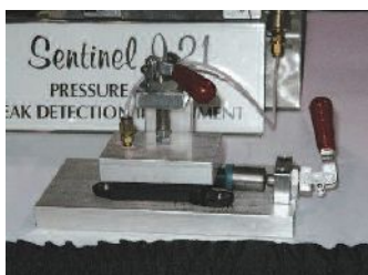
Modèle 602-MM utilisé sur un poste de tests d'étanchéité
