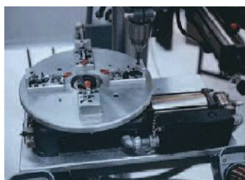
Modèle 205-S utilisé sur un poste de perçage semi-automatisé
