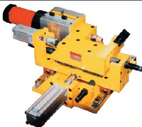
Machine spéciale ; 2 poinçonnages Ø 12 dans de l'acier ; épaisseur 1,2 mm
