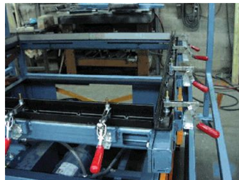
Tension d'un film plastique à l'aide de serrages 317-U-LS
